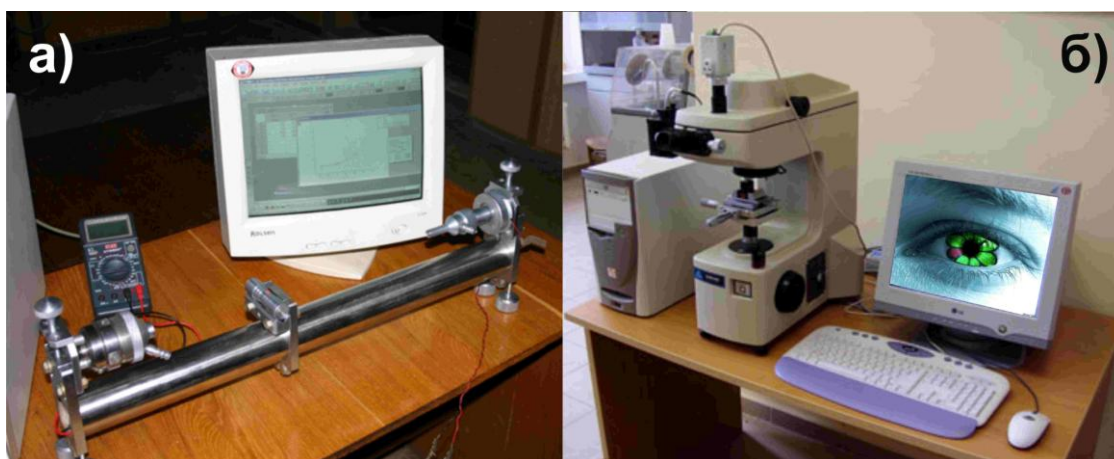
Рис. 3. Лазерный измеритель линейных размеров (а), комплекс технического зрения (б).
