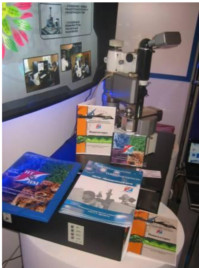
Универсальный динамический нанотестер, разработанный в УИЦ «НТиНМ»
