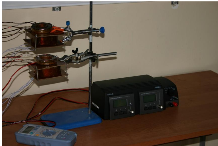
Лабораторный макет установки по электромагнитной обработке рудного сырья для увеличения извлекаемости полезных ископаемых в микро- и субмикро объемах
